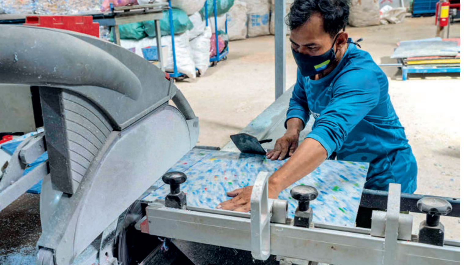
Hier werden Platten für den Möbelbau gesägt, die aus recyceltem Kunststoff hergestellt wurden.
